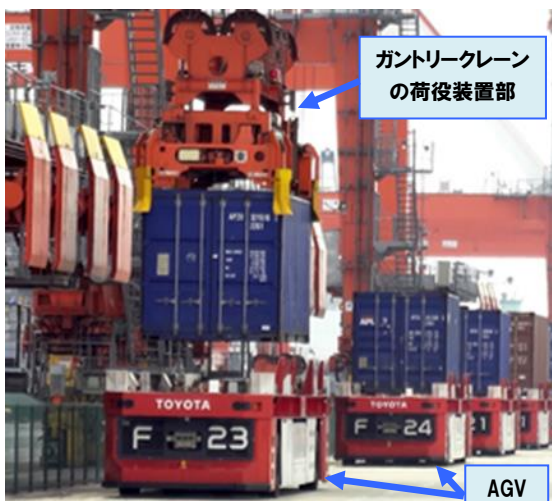
図1. AGVと荷役するガントリークレーン
